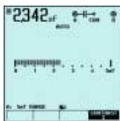
Verifique o capacitor de partida a um motor com o ScopeMeter 124
